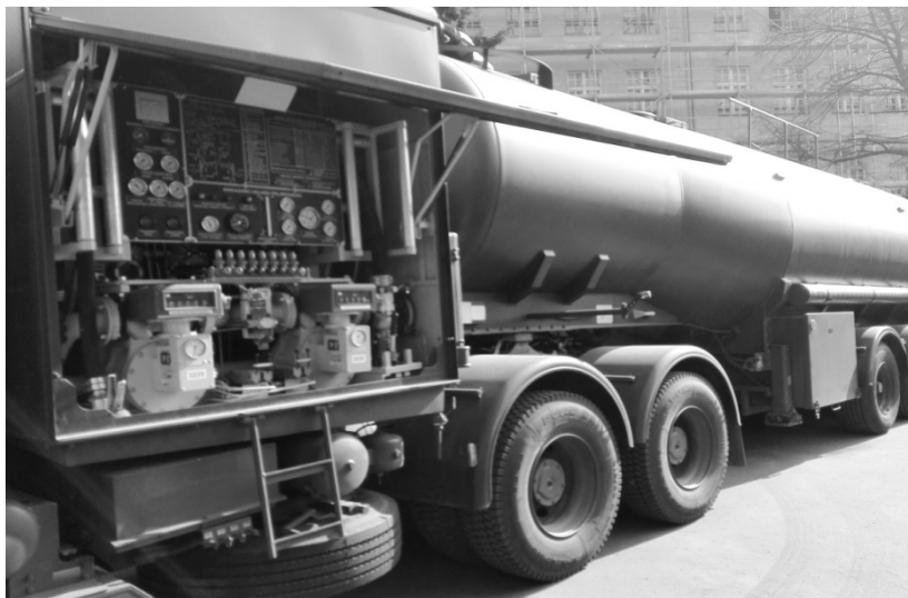
Rysunek 2 Węzeł dystrybucyjny cysterny – dystrybutora lotniskowego CND-33
