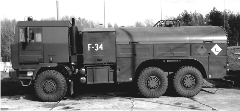
Rysunek 1. Cysterna – dystrybutor lotniskowy CD-10 (o pojemności 10 m 3 )
