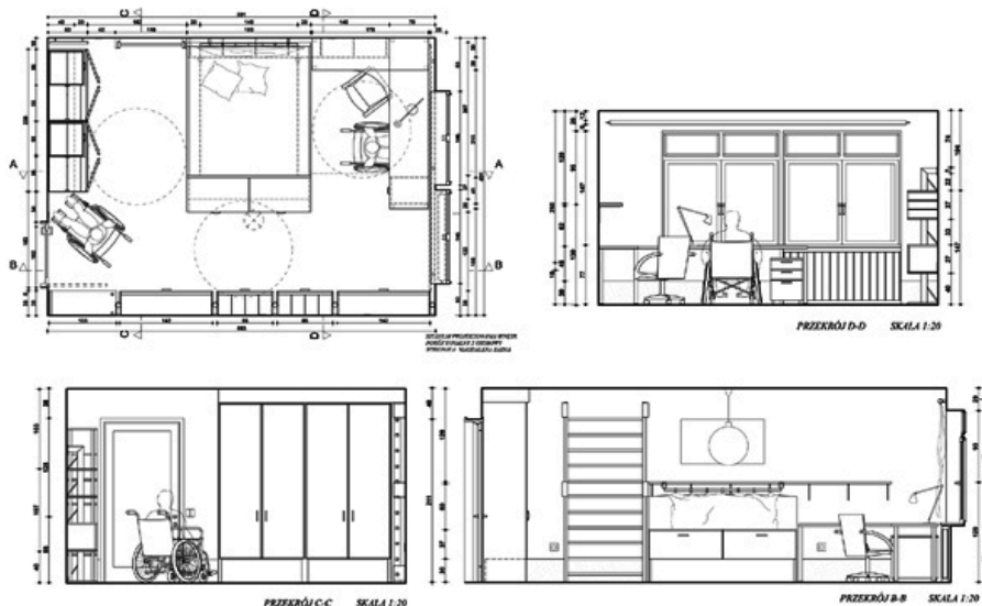
Rys. 3. Rzut pokoju przystosowanego dla osoby niepełnosprawnej
